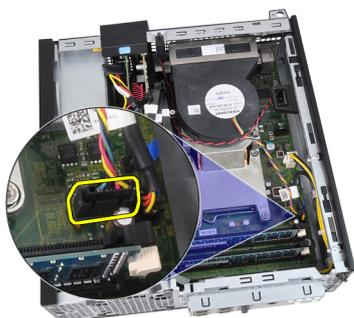
6. Solte o cabo do painel de entrada/saída / cabo FlyWire do encaminhamento no dissipador de calor.
