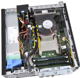
7. Utilize uma chave de fendas Phillips para desapertar os parafusos integrados (1 > 2 > 3 > 4) que fixam o conjunto do dissipador de calor e do ventilador à placa de sistema.
