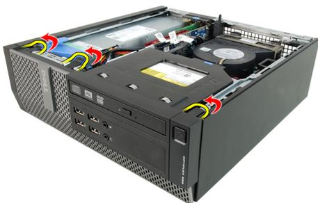
4. Rode e retire a moldura do computador para soltar do chassis os ganchos existentes na extremidade oposta da moldura.
