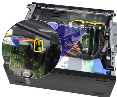
6. Retire o cabo do interruptor de alimentação do grampo no chassis.
