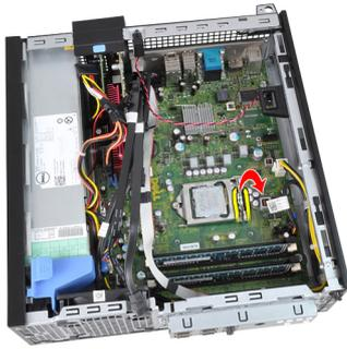
11. Levante o processador para o remover do encaixe e coloque-o numa embalagem antiestática.
