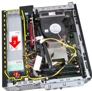
11. Levante a fonte de alimentação e retire-a do computador.
