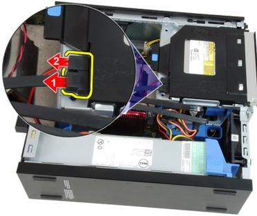
5. Faça deslizar a alça da caixa da unidade em direcção à parte posterior do sistema para a posição de desbloqueada.
