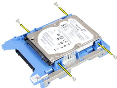
6. Retire os quatro parafusos que fixam a unidade de disco rígido de 2,5 polegadas à parte inferior do suporte da unidade de disco rígido.
