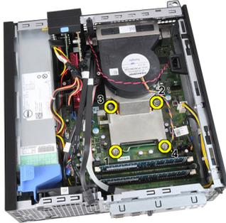
8. Com cuidado, levante o conjunto do dissipador de calor e ventoinha e remova-o do computador. Coloque o conjunto com a ventoinha voltada para baixo e com a massa térmica para cima.
