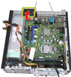
10. Utilize uma chave de fendas Phillips para retirar os parafusos que fixam a placa de sistema ao chassis.
