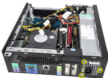
10. Carregue na patilha de desbloqueio azul junto à fonte de alimentação, e faça deslizar a fonte de alimentação em direcção à parte anterior do computador.
