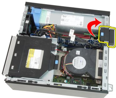
5. Com cuidado, afaste a alavanca de desbloqueio da placa PCIe x16 até soltar a patilha de fixação do entalhe na placa. Em seguida, liberte a placa do respectivo conector e retire-a do computador.
