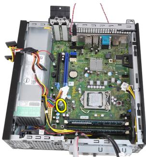
12. Faça deslizar a placa de sistema em direcção à parte anterior do computador.
