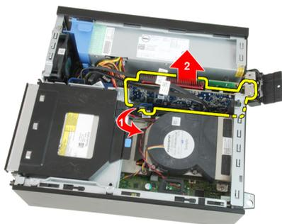
6. Com cuidado, afaste a alavanca de desbloqueio da placa PCIe x4 (se existir) até soltar a patilha de fixação do entalhe na placa. Em seguida, liberte a placa do respectivo conector e retire-a do computador.
