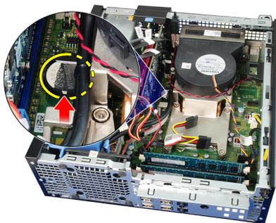
5. Retire a bateria de célula tipo moeda do computador e elimine-a de forma apropriada.
