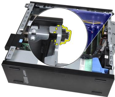
8. Faça deslizar o cabo do interruptor de alimentação para fora da parte frontal do computador.
