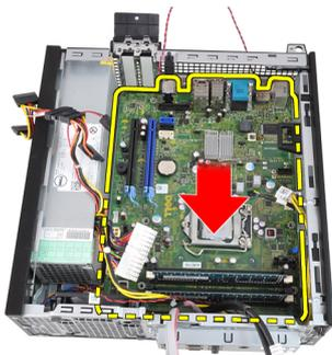
13. Retire a placa de sistema do chassis.
