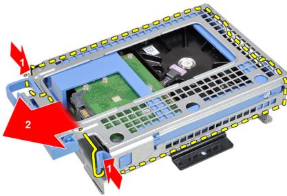
4. Flicta o suporte da unidade de disco rígido e depois retire a unidade de disco rígido de 3,5 polegadas ou as duas unidades de disco rígido de 2,5 polegadas do suporte.
