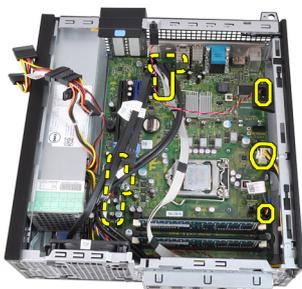
9. Levante e solte o trinco da placa de expansão, para aceder aos parafusos que fixam a placa de sistema.
