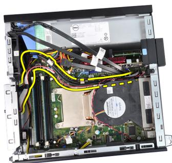
6. Desligue o painel de entrada/saída / cabo FlyWire da placa de sistema.
